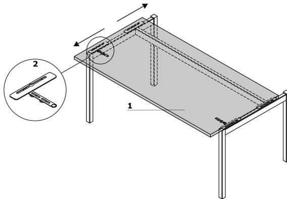
1. Schiebeplatte – Schiebebereich 141 mm
